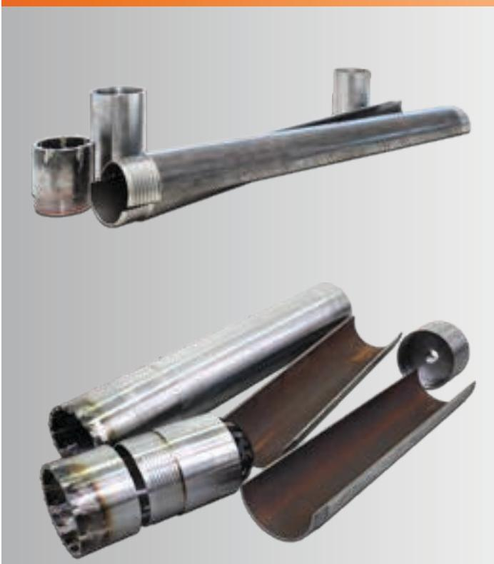
Principale caratteristica di questo carotiere è il tubo in acciaio divisibile che semplifica il trasferimento della carota senza aver nessun disturbo per ottenere un campione perfetto per le analisi. Il carotiere è personalizzabile e producibile in diversi diametri a seconda delle esigenze, fino al diametro 244 mm. È possibile usare una scarpa avanzata, estrattori a cestello etc. Il carotiere ambientale standard è dotato di attacco per le corone del carotiere semplice T1.
