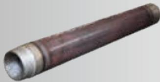
La nostra gamma di Tubi di Rivestimento viene realizzata attraverso la saldatura dei manicotti in acciaio 42CrMo4 ad un tubo intermedio in materiale N80. I manicotti inoltre, sono sottoposti ad un processo di nitrurazione, al fine di garantirne un' ancor maggiore resistenza all'usura del filetto. La certificata qualità degli acciai utilizzati, abbinata all'efficiente processo produttivo, ci permette di offrire ai nostri clienti le migliori prestazioni di prodotto presenti sul mercato.
