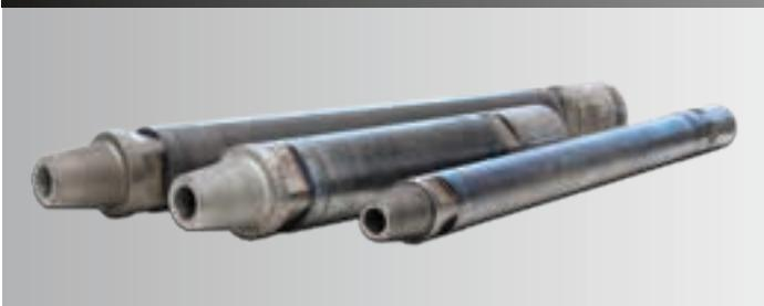
Le aste di perforazione dell'Arena S.r.l. sono prodotte da tubi senza saldatura in acciaio 42CrMo4 bonificato. I manicotti, saldati con processo di forgiatura a mezzo frizione, sono filettati secondo le specifiche Api e sottoposti a trattamento antigrippaggio.
