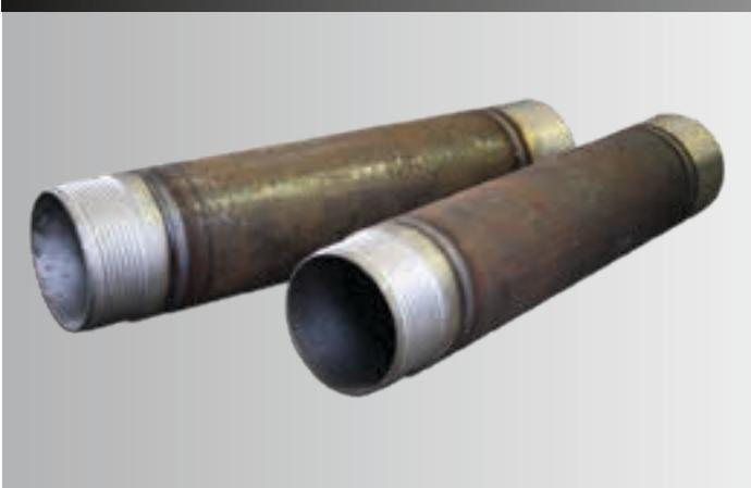
La nostra gamma di Tubi di Rivestimento viene realizzata attraverso la saldatura dei manicotti in acciaio 42CrMo4 ad un tubo intermedio in materiale N80. I manicotti inoltre, sono sottoposti ad un processo di nitrurazione, al fine di garantirne un' ancor maggiore resistenza all'usura del filetto.
