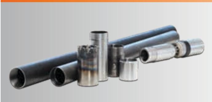
Il tipo T2 è un carotiere a pareti sottili adatto al carotaggio con acqua di terreni omogenei e/o fratturati. Gli spessori ridotti permettono alte velocità di penetrazione e carote di maggior diametro, oltre a una minore usura delle attrezature.
